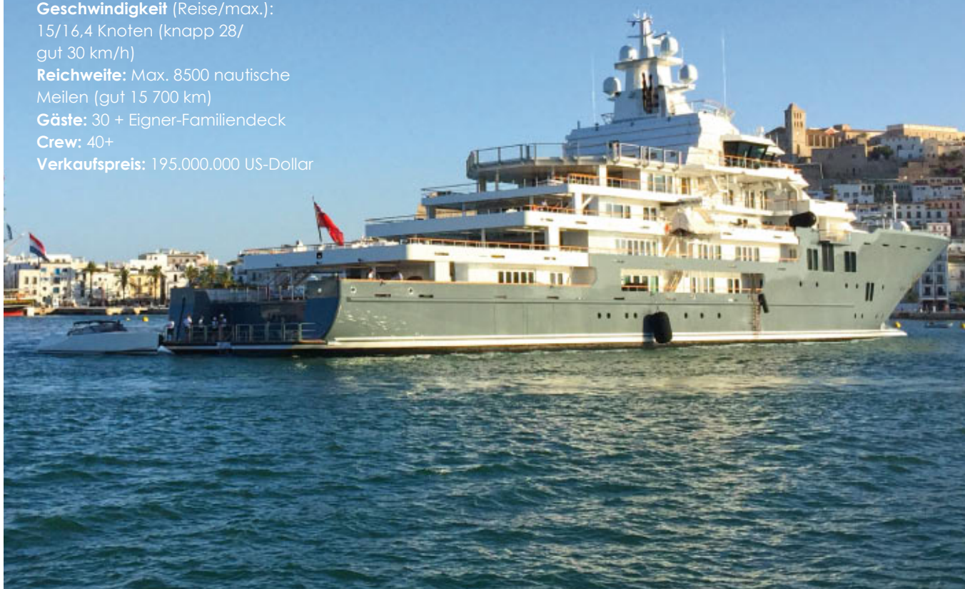
Bild oben: Hinter der Kommandobrücke erstreckt sich die Hubschrauber-Plattform. Die gesamte Wand davor ist das Hangar-Tor. In der Halle ist der Helikopter wettergeschützt und kann gewartet werden. Die Landeplattform dient auch als Basketball-Platz
