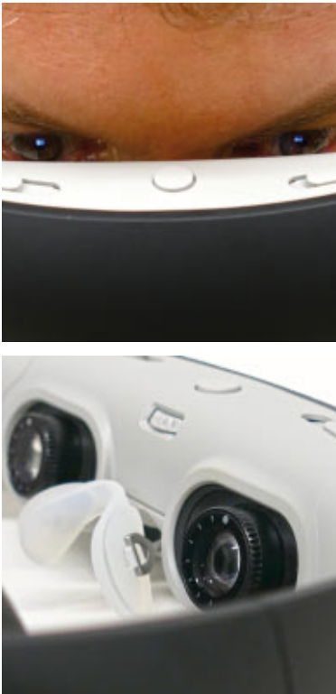
Die Glyph projiziert die Bilder über Linsen direkt in die Augen. Sie beherrscht 2D- und 3D. Mit eingeschobenen Linsen und abgenommenem Nasen-Pad wird sie zum Kopfhörer. Der Sound beim Film-Schauen ist leider nur bedingt einstellbar
