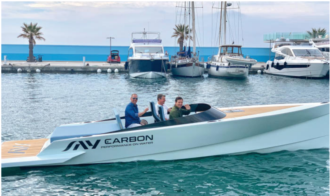
Vom Hafen Santa Eulària ging es zu Fahrdynamik-Tests in die Cala Llonga. Die große Heck-Platte verhindert starke Seitenneigungen in den Kurven. Bei Höchstgeschwindigkeit, auf flacher See, sind nur noch sie und der Antrieb mit dem Wasser in Berührung
