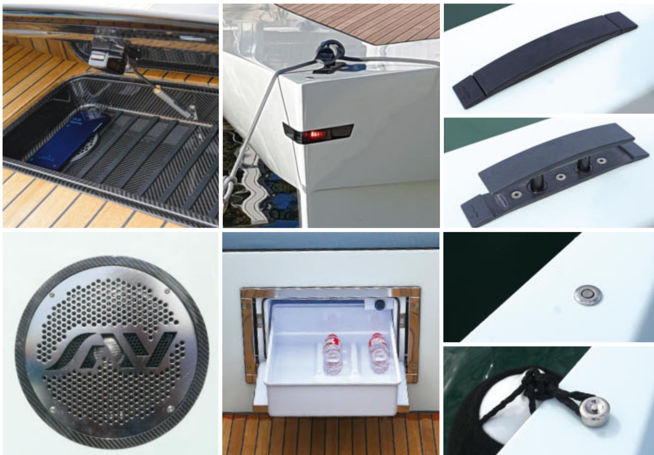
Das geschützte Fach ist mit kabelloser Ladefunktion fürs Smartphone ausgestattet. Per Bluetooth wird die Sound-Anlage gefüttert. Die einzigen festen Positionslichter sind die Backbord/Steuerbord-Leuchten im kleinen Schlitz am Bug. Das Kühlfach sorgt für kalte Drinks. Klampen werden im Rumpf versenkt, Fender per Klick-System in kleine Edelstahl-Aufnahmen gesteckt
