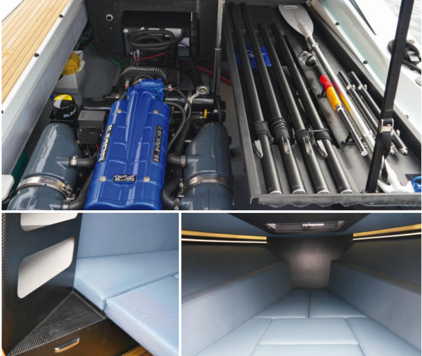
Sicht-Carbon, wo man hinschaut. Unter Deck mit LED-Lichttechnik ist Platz zum Liegen, etwas Stauraum und eine kleine Toilette. Auch der Motorraum steckt voll Carbon. Ordentlich verstaut, unter anderem: Einsteckbare Elemente fürs Sonnensegel, Positionslicht und die Griffe der Badeleiter. Der Benziner von Ilmor leistet 483 PS und sorgt für Beschleunigungswerte eines Porsche Panamera
