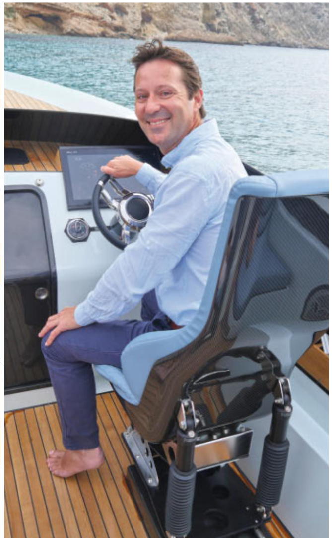
Alles im Blick: Statt klassischer Anzeigen liefert das große Display alle Informationen rund um Schiffs-Werte und Fahrleistungen. S.E. Yachting-Chef James Blanchfield am Steuer. Der gefederte High-Tech Sitz aus Kohlefaser ist voll renntauglich
